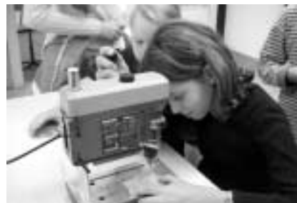
Platinen werden gebohrt
